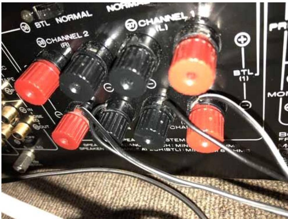
同様に出力を確認する（リア側 60W+60W 8Ω 1000HZ）
