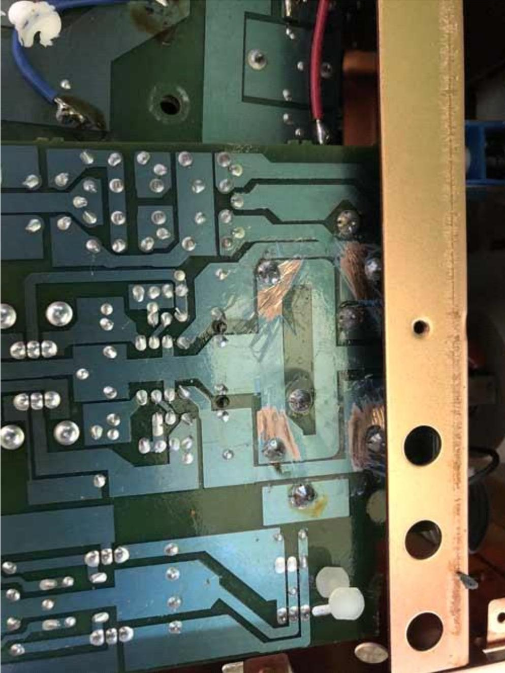
はんだ修正後、他にトランジスタの足や定電圧部のコンデンサーの足もはんだ修正する
