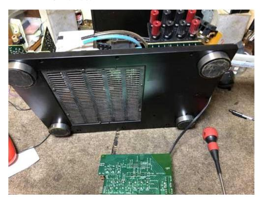
セレクター基板のはんだ修正とスイッチの接点改善をする
